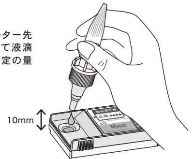
③ 試料滴下後、直ちに機器のテストカートリッジ挿入口に挿入し、テストカートリッジ挿入口のカバーを閉じて下さい。
