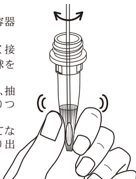
③ フィルターを装着して、容器を数回、軽く揺すって十分混和し、試料とします。
